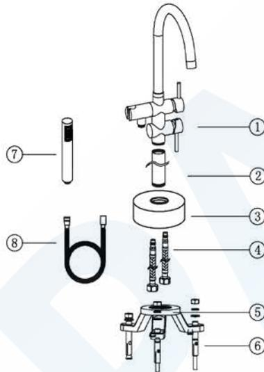
1. Conectar el soporte con la tapa decorativa y enroscar en el tubo recto. Introducir ambos latiguillos por el tubo.
