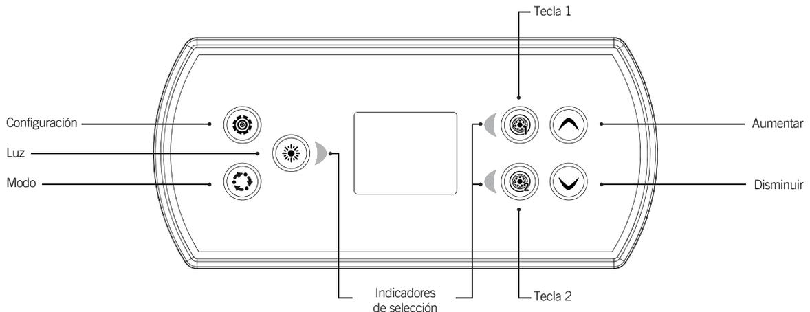
\* Las funciones de las teclas 1 y 2 dependen de la configuración a nivel inferior de su sistema.
